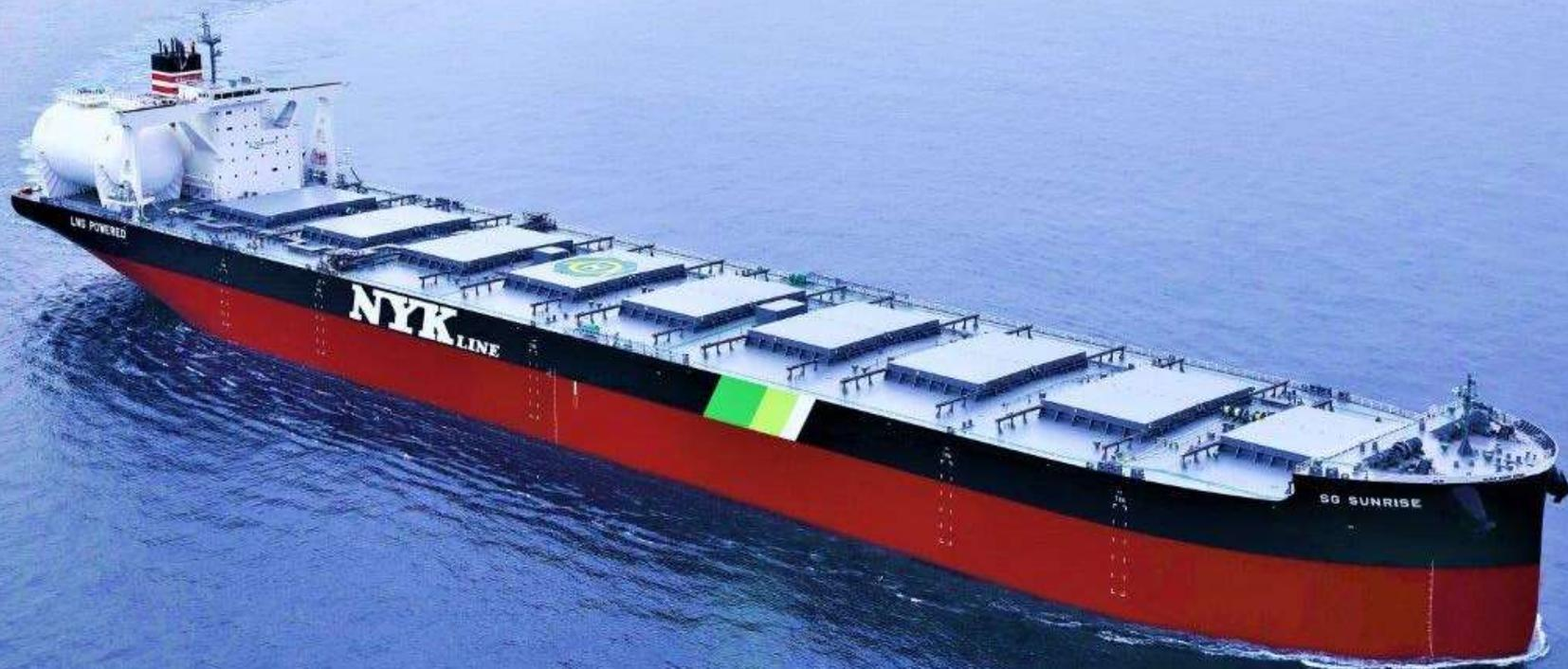
21万1千トン型LNG/MGO 二元燃料撤積運搬船
