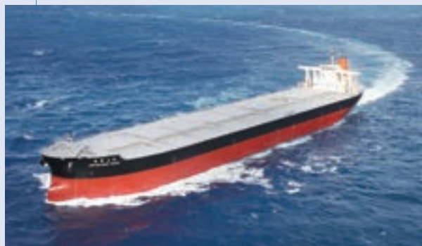
【船 名】AWOBASAN MARU(南葉山丸) 【船 種】鉱石運搬船 【載貨重量】226,371トン 【寸 法】長さ319.58m×幅54.00m×深さ25.10m 【引 渡 日】平成25年12月3日
