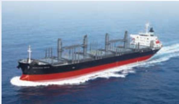
【船名】ANDALUCIAN ZEPHYR 【船種】散積運搬船 【載貨重量】34,436トン 【寸法】長さ179.96m×幅30.00m×深さ14.05m 【引渡日】平成26年3月12日
