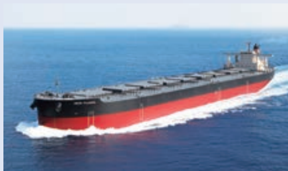
【船 名】IRON PILBARA 【船 種】鉱石運搬船 【載貨重量】250,895トン 【寸 法】長さ329.95m×幅57.00m×深さ25.10m 【引 渡 日】平成26年2月4日
