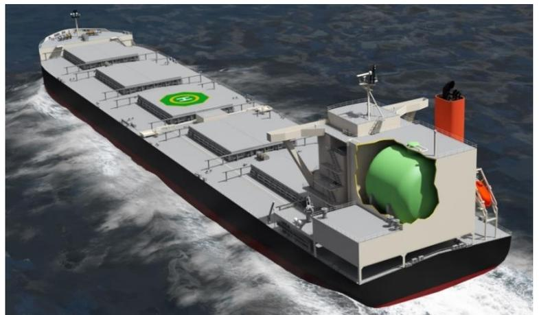
環境規制が国際的に強化される中、船舶においても地球温暖化の原因となる二酸化炭素(CO<sub>2</sub>)、大気汚染の原因となる硫黄酸化物(SO<sub>x</sub>)や窒素酸化物(NO<sub>x</sub>)の排出基準が国際海事機関(IMO)により段階的に定められています。本船は、燃料にLNGを使用することにより、SO<sub>x</sub>はもとより、NO<sub>x</sub>やCO<sub>2</sub>の排出量も重油を燃料とする船舶に比べ大幅に削減することができます。
