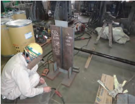
写真1 CO<sub>2</sub>半自動溶接試験施工状況
