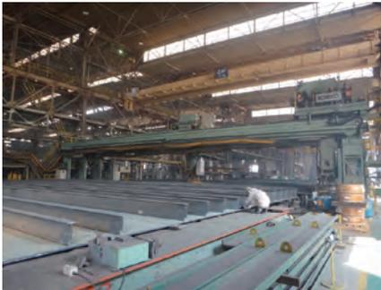
写真2 FCB 溶接装置
