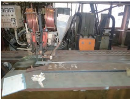
写真3 FAB 溶接施工試験状況
