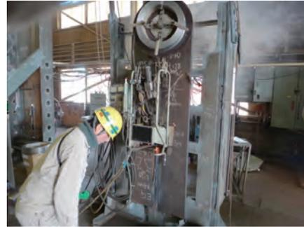
写真4 EG 溶接施工試験状況
