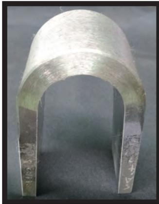
写真6 曲げ試験片
