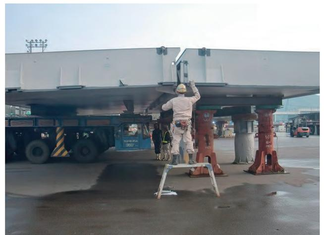
写真9 ブロック搬送台車を利用したハッチカバーの連結
