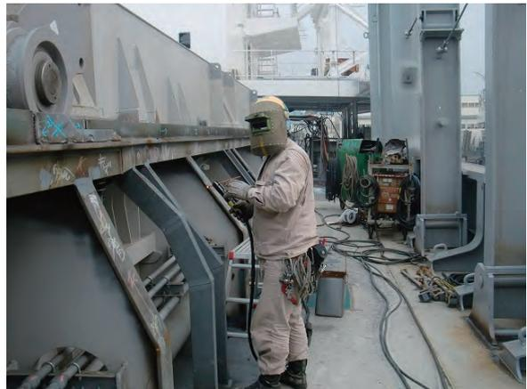
写真6 進水後の艀装船での手直し工事風景
