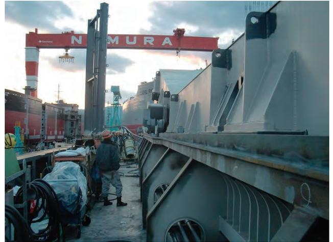
写真8 油圧により開放されるハッチカバー
