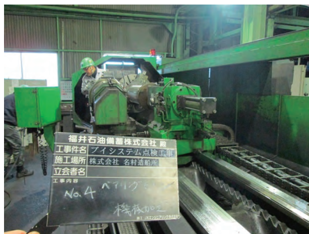
写真 24 軸ピンの機械加工状況
