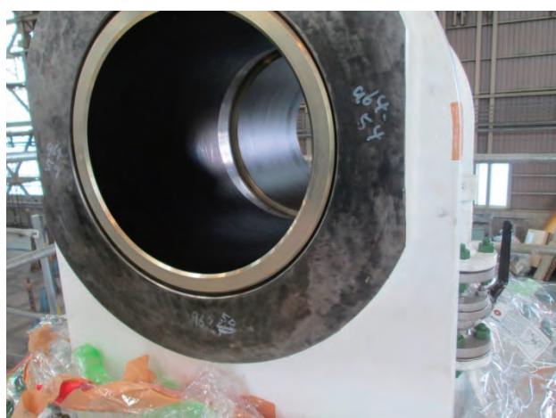
写真 27 整備後の軸受状況
