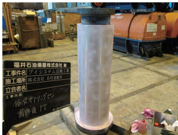
写真 25 補修後、非破壊検査状況
