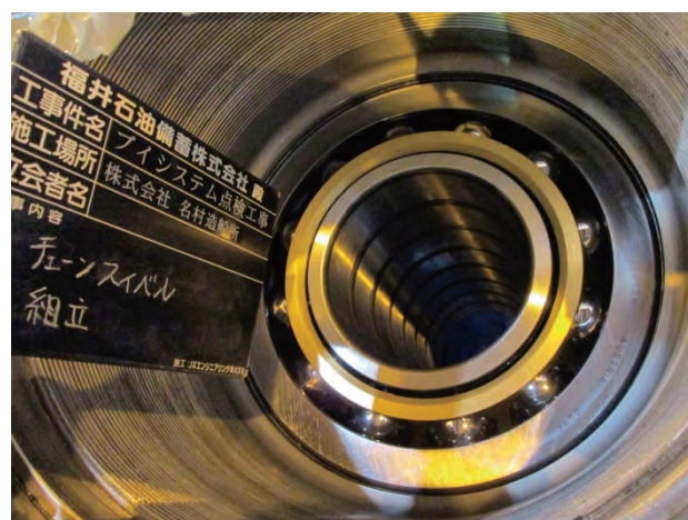
写真 31 チェーンスィベル胴体内部のベアリング入替
