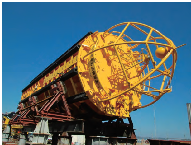
写真 35 ブイ本体整備完了(トップ面側)
