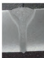
写真 2 突合せ溶接断面
