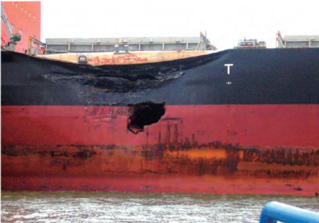
写真2 衝突事故による船側の損傷
