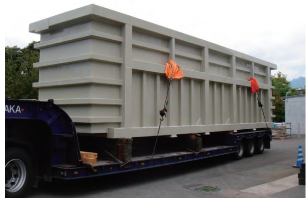
写真1 塩酸槽(出荷状況)
