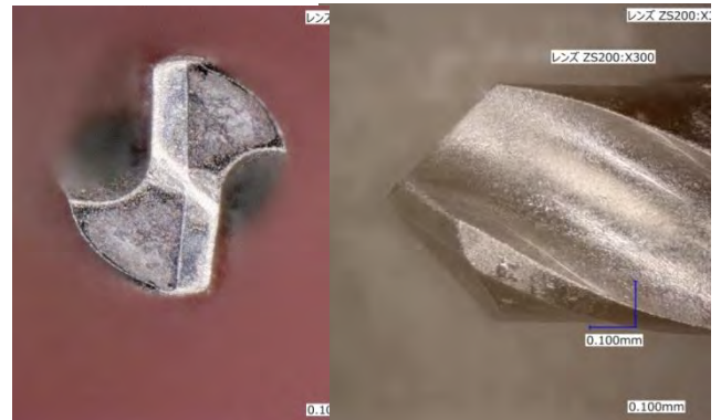
写真10 超音波援用加工 1000 穴加工後のドリル ( \phi 0.5 )
