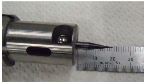
写真 15 専用ツールホルダとツール(φ0.3 エンドミル)
