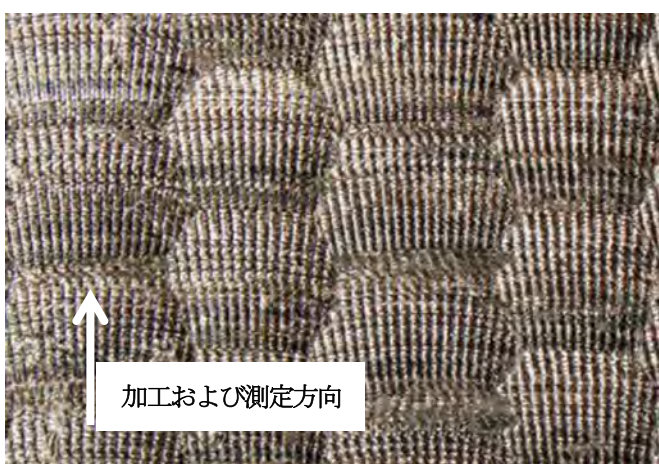
写真6 超音波援用加工後の表面（200倍）
