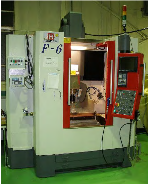
写真 18 超音波ホルダを装着したマシニングセンタ
