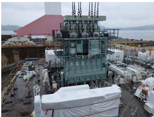
写真8 AD搭載前の主機搭載(34BC)
