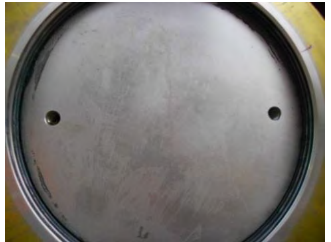
写真10 (改善前) 軸中心の不明なプロペラ軸トモ端面
