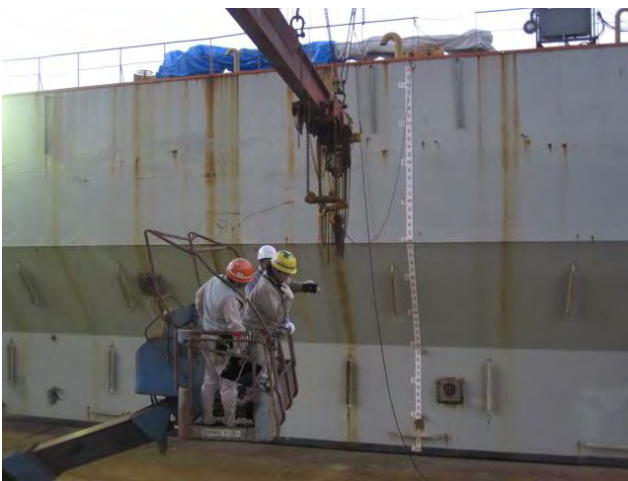
写真3 舵芯(ピアノ線)とのズレ確認
