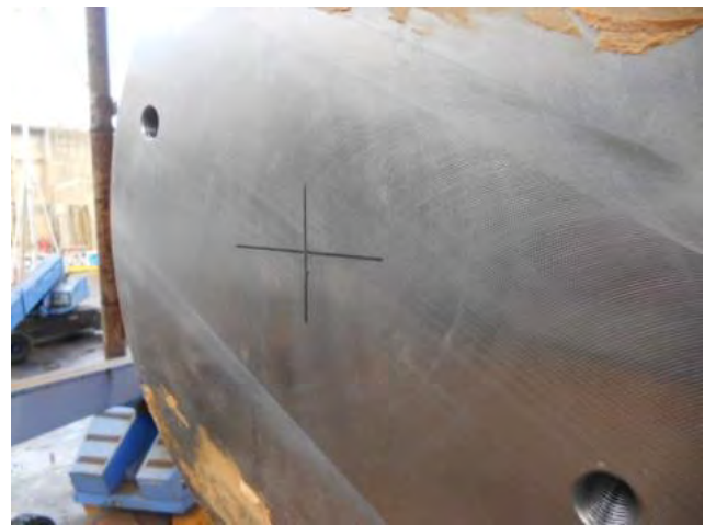
写真11 (改善後) 軸中心のポンチ穴とマーカー
