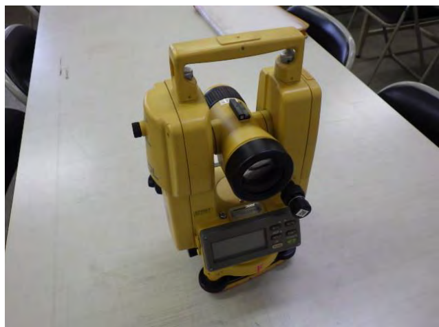
写真 12 焦点調整機能があるトランシット
