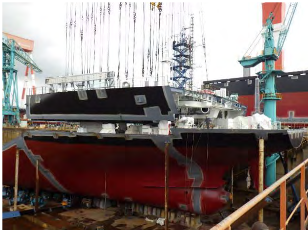
写真9 主機搭載翌日のAD1搭載
