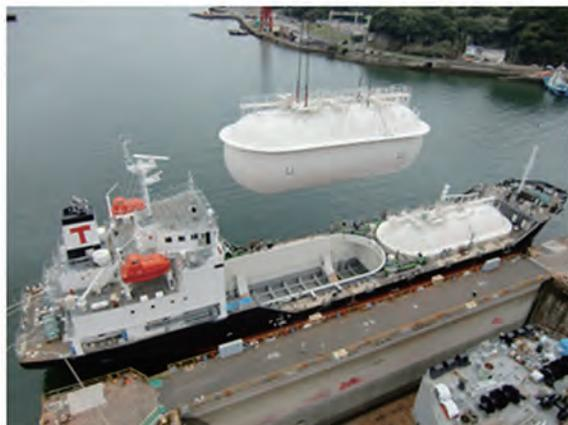
写真7 3,500m<sup>3</sup>船用LPGタンクシステム(1,750×2基)
