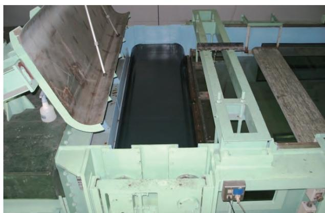
写真4 表面流加速装置
