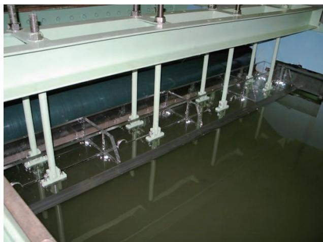
写真5 制波板 (透明アクリル製)
