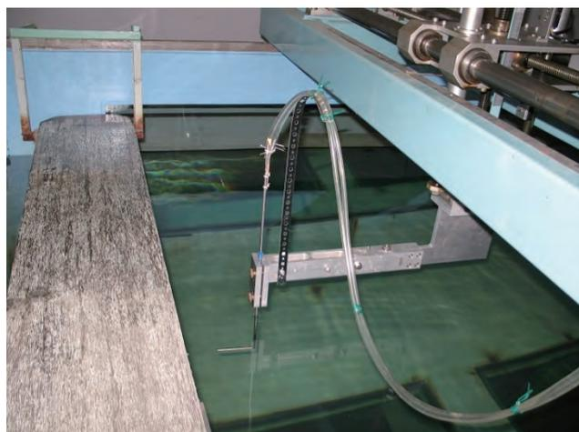
写真14 ピトー管による流場計測
