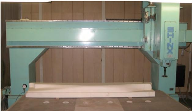
写真17 NC 模型船切削機
