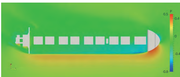
第 29 図 従来型の上部構造物+船体模型周辺の甲板上の圧力分布 \Psi=60^\circ CFD 計算結果(SA モデル) y 軸:船長方向
