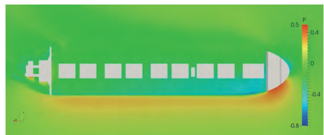
第26図 従来型の上部構造物+船体模型周辺の甲板上の圧 力分布 \Psi=60^\circ CFD計算結果(SAモデル) x軸:船長方向
