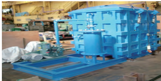
矩形真空含浸装置（出荷前）
