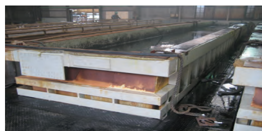
従来型 PP 製酸洗槽の設置状況
