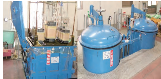
矩形と丸形真空含浸装置の設置状況
