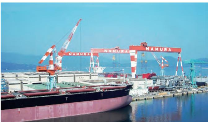
写真10 2基の800Tゴライアスクレーン全景
