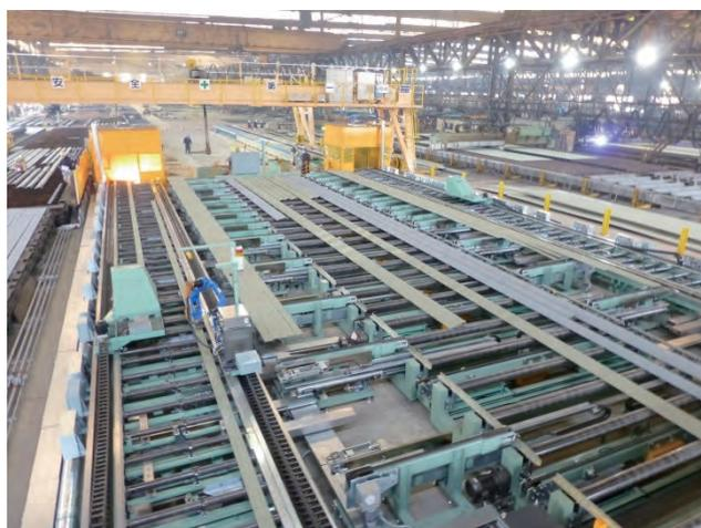
写真4 受入コンベアと待機コンベア
