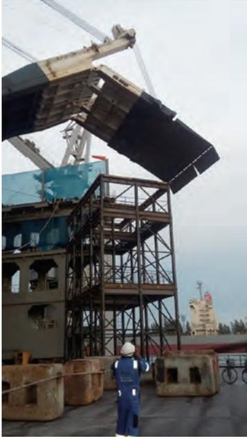
写真8 FD#3 でのランプ開閉時の様子
