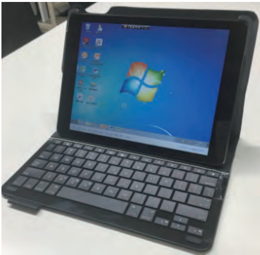
写真 2 シンククライアント iPad 外観①
