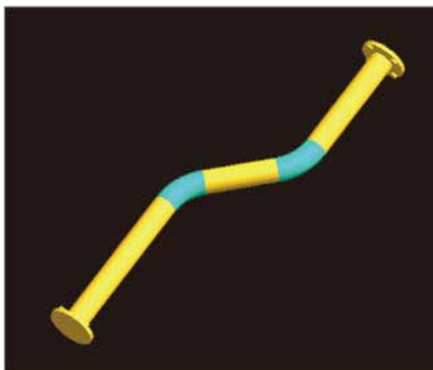
第 5 図 内面塗装曲げ管
