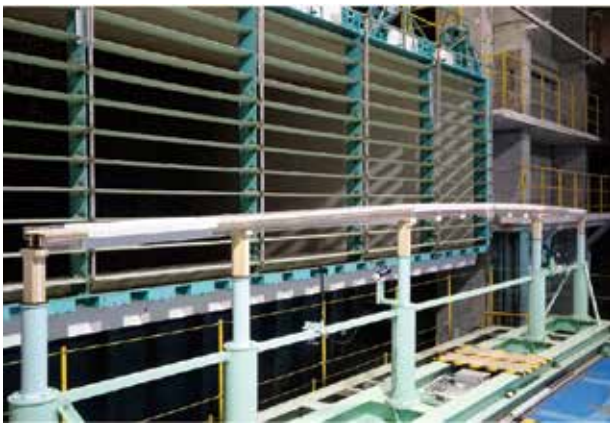
写真 10 架設形の空力対策試験
