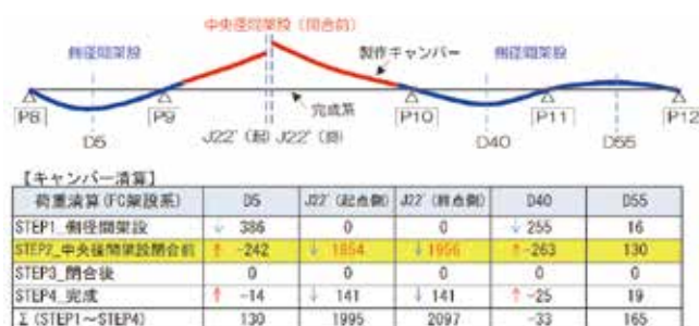
第13図 閉合直前のたわみ計算結果
