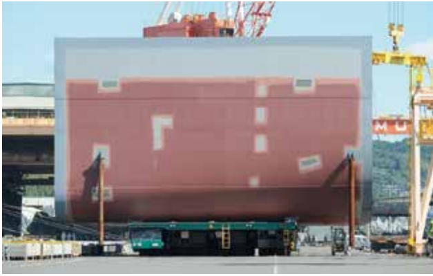
写真6 1,000t 自走台車で運搬される大型ブロック
