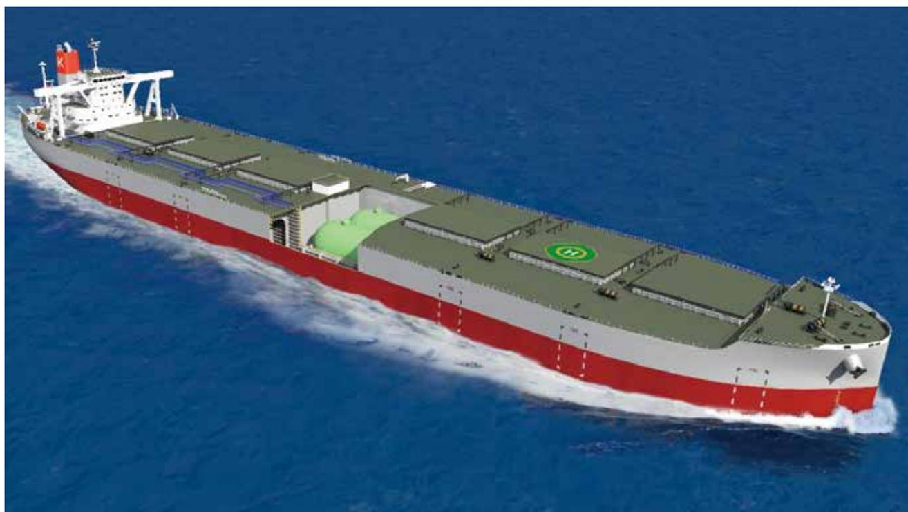
第1図 LNG燃料鉱石船イメージ
