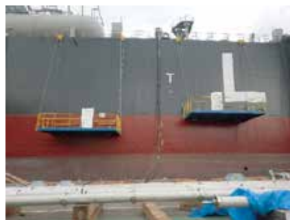
写真4 LPG 船建造時 避難用ステージ
