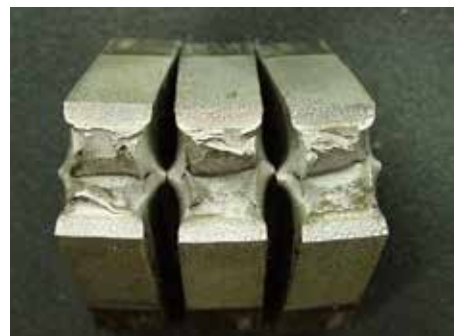
写真11 試験後の衝撃試験片一例
