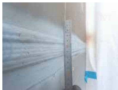
写真 22 実船での石松ビード外観
