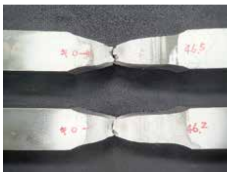
写真8 試験後の引張試験片一例
