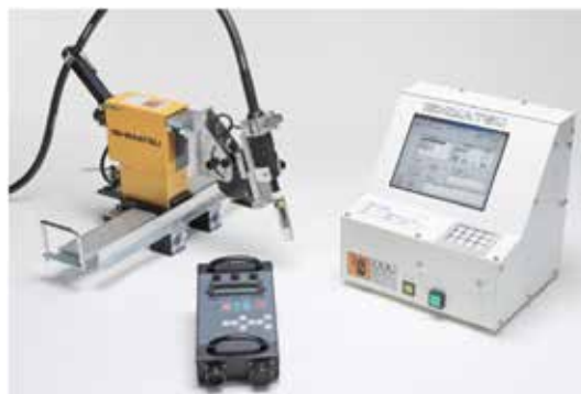
写真1 小型可搬形溶接ロボット石松 3)
