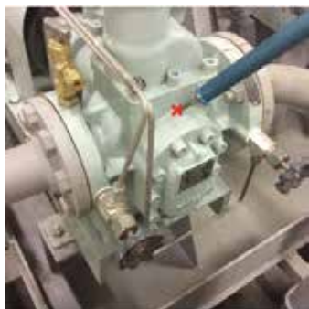
写真 4 G.E. MGO/MDO SUPPLY PUMP ギヤ部の聴音箇所
