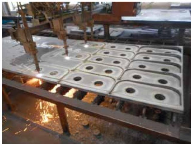
写真5 新規製作中の吊りピース
