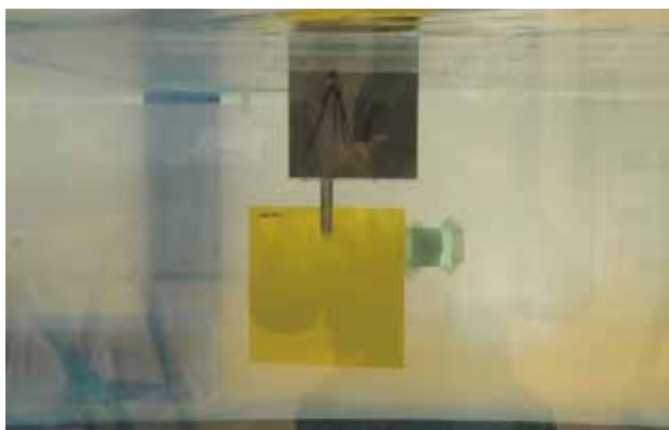
第8図 水槽試験による帆の性能確認
