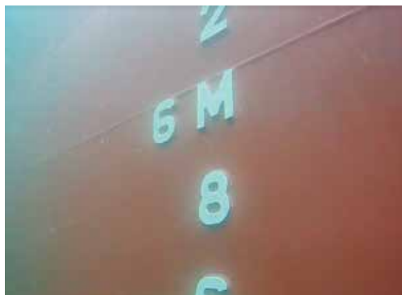
写真7 ドラフトマーク撮影 (水中)
