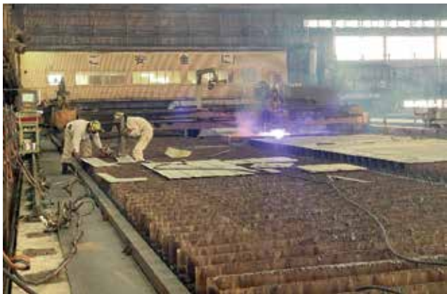
写真6 自動運転で切断中の作業
