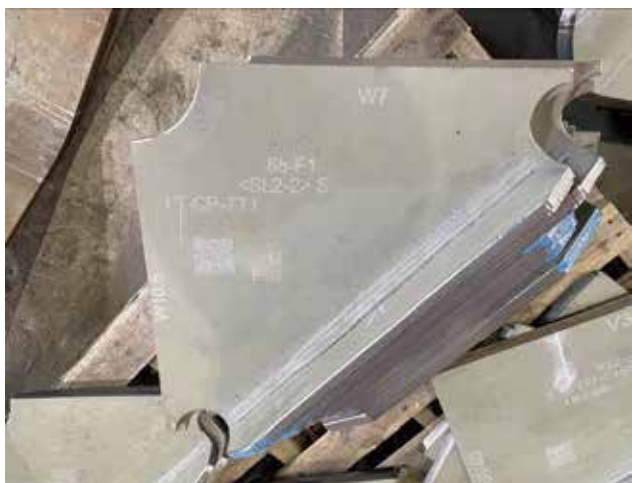
写真3 鋼板印字装置によって印字されたQRコード
